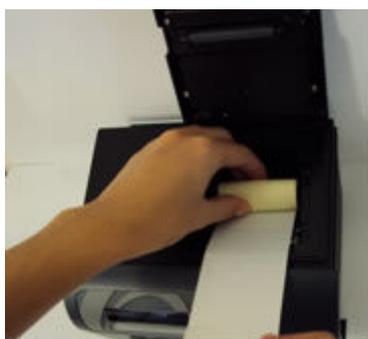
Coloque a nova bobina no compartimento.
